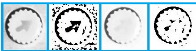
Obr. 2.32: Zhoršení kontroly natočení trimru pro postranní osvětlení
