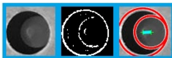
Obr. 2.21: Postup vyhodnocení souměrnosti LED s krytem
