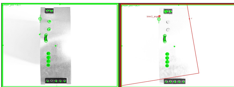
Obr. 1.15: Identifikace komponent vzorku pro postranní osvětlení
