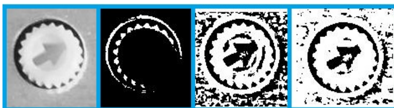
Obr. 2.12: Vliv nastavení výpočtu prahové hodnoty na výstupní binární snímek
