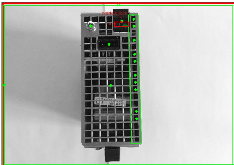
Obr. 1.19: Výchozí stav výstupu testovacího algoritmu pro spodní/vrchní kryt
