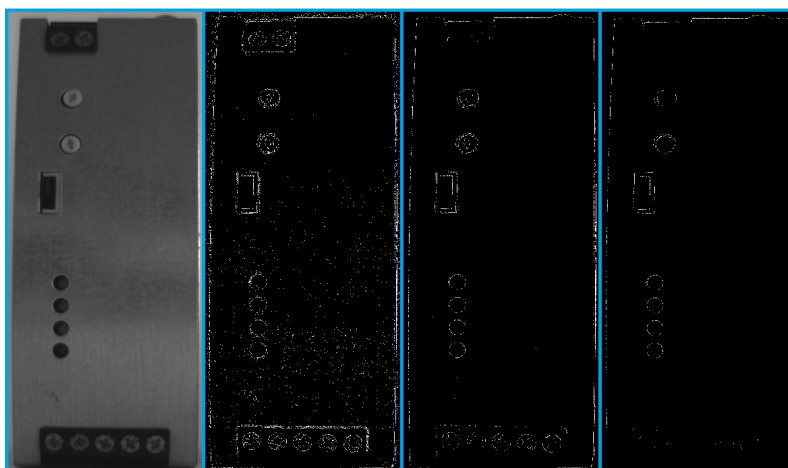
Obr. 2.4: Hranový obrázek Sobelova detektoru pro různé prahové hodnoty
