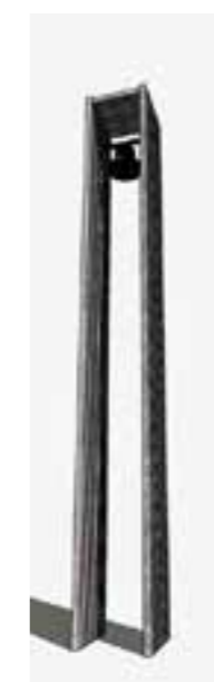
Zvonice - vlastní design výška: 8 m Profil latí: 40x40 mm, borovice Materiál zvonu: zvonovina
