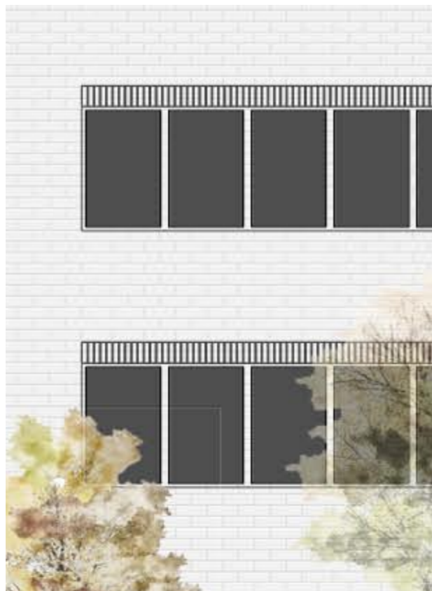
POHLEDOVÉ BÍLE CIHLY, OKNA S CIHELNÝM NADPRAŽÍM
