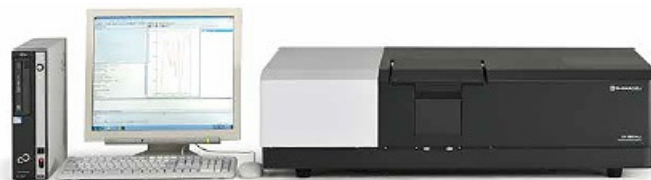
Obrázek 3.2: Přístroj pro měření absorpčních spekter UV-VIS-NIR Shimadzu UV-3600 [48].
