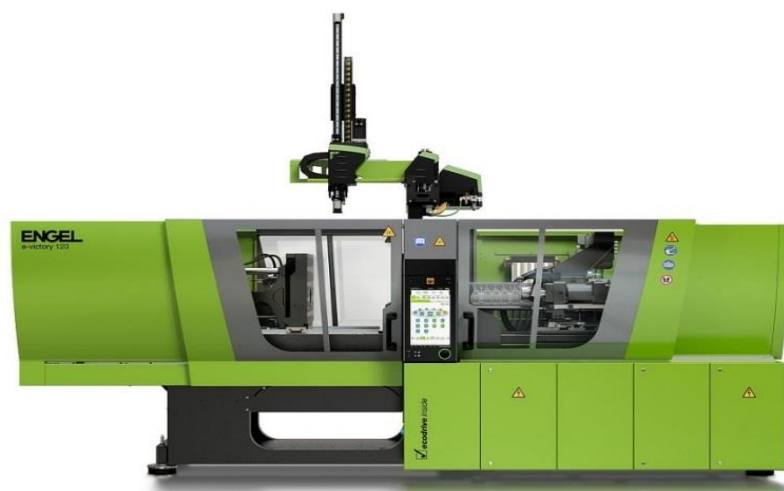
Obrázok 16: Vstrekolis ENGEL s riadením CC 300 (Dostupné z: http://www.rama-cz.com/vstrikolisyl/ )
