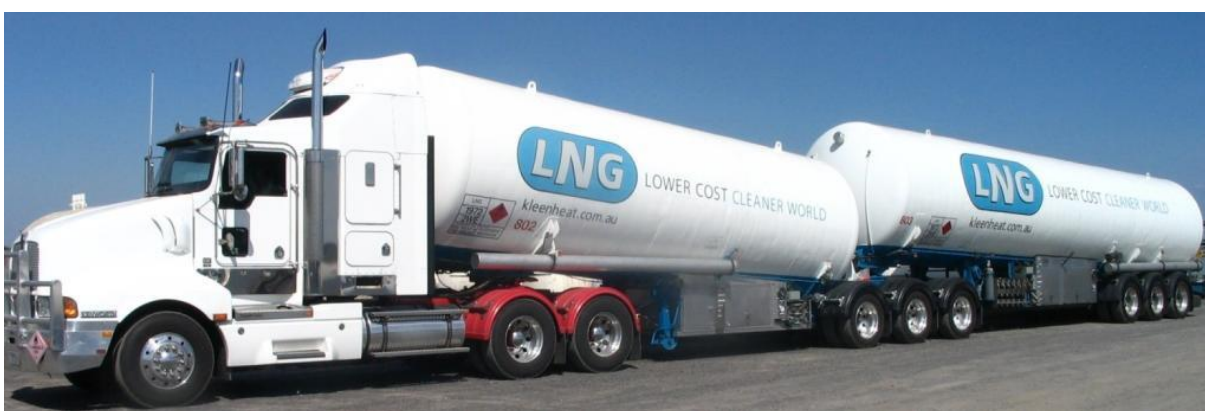
Obrázek 3.2 Převoz LNG silniční dopravou (zdroj: Chart Ferox, a.s.)
