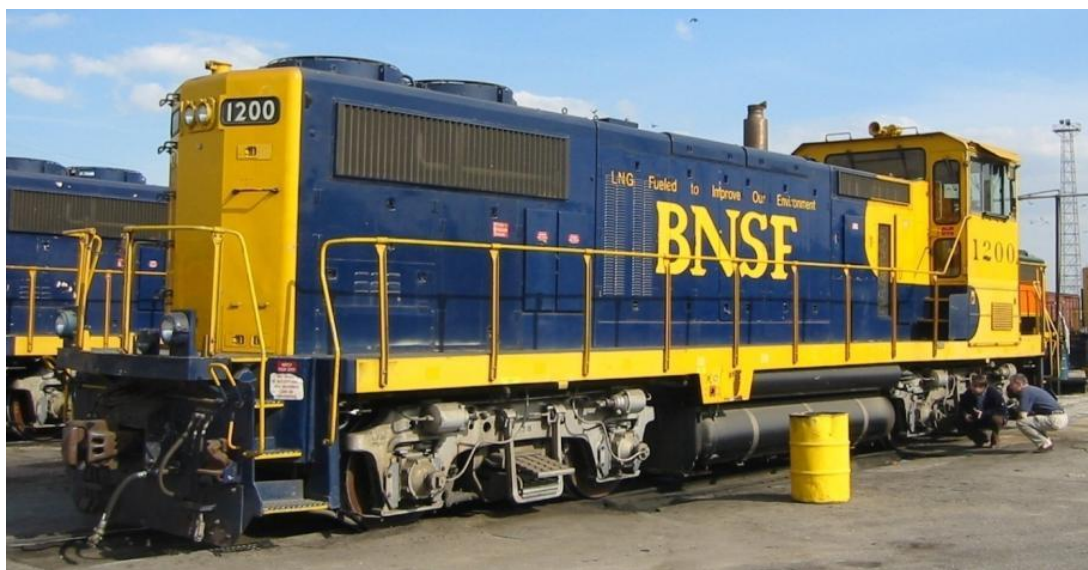
Obrázek 4.3 Posunovací lokomotiva na duální palivo LNG a motorová nafta (zdroj: Chart Ferox, a.s.)
