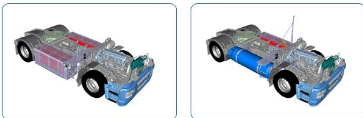
Obrázek 9.1 Možnosti umístění nádrží: 2xCNG, dojezd do 570 km a CNG+LNG, dojezd do 1100 km (zdroj: IVECO Czech Republic, a.s.)
