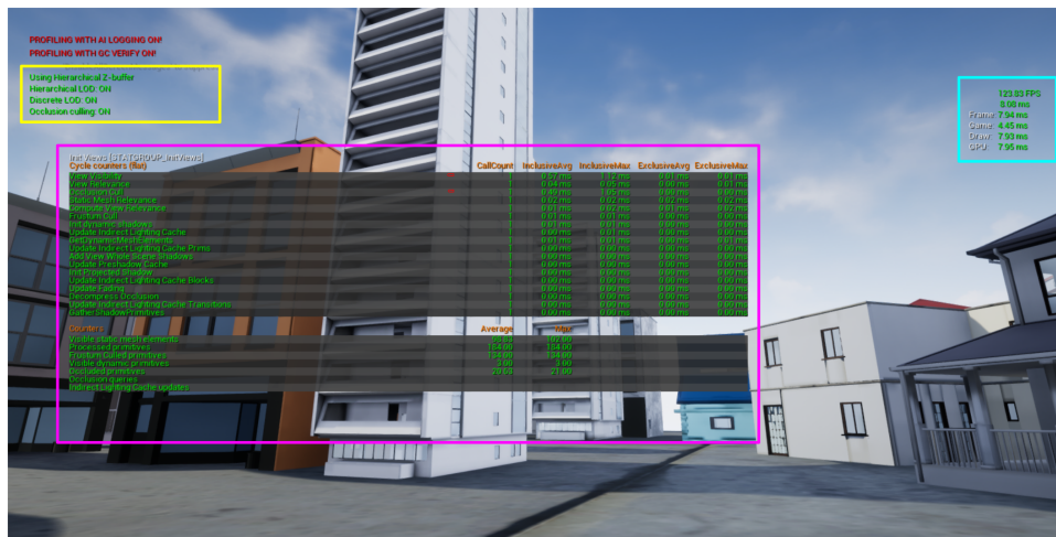
Obrázek 8.11: Ukázka uspořádání informací v prototypu: žluté ohraničení obsahuje informace o spínání optimalizačních technik, růžové ohraničení definuje místo pro statistické tabulky, modré ohraničení znázorňuje informace o rychlosti vykreslování a frekvenci snímků
