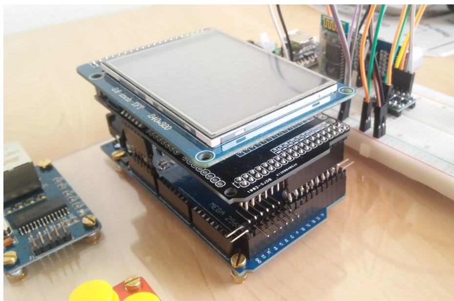
Obrázek 4.2: Zapojení TFT LCD modulu do desky Arduino Mega 2560
