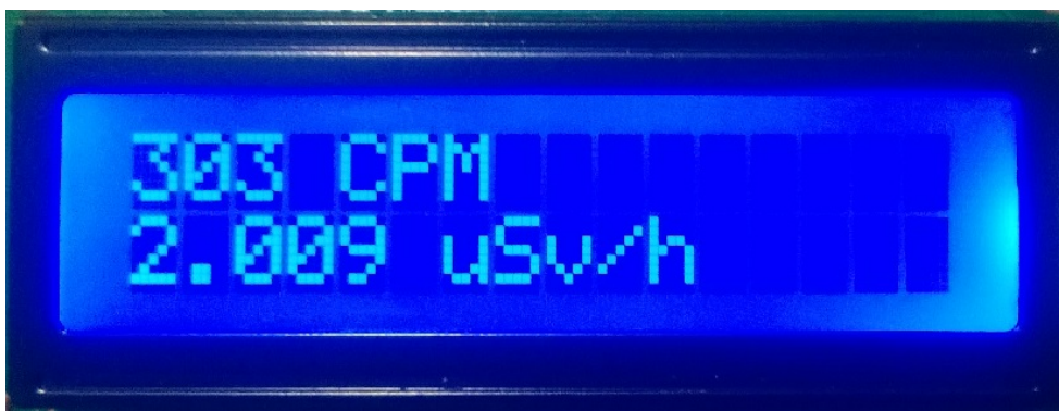
Obrázek 3.3: LCD displej – základní režim; nahoře hodnota naměřených Counts per minute; dole hodnota ekvivalentního dávkového příkonu v \mu\text{Sv/h} .
