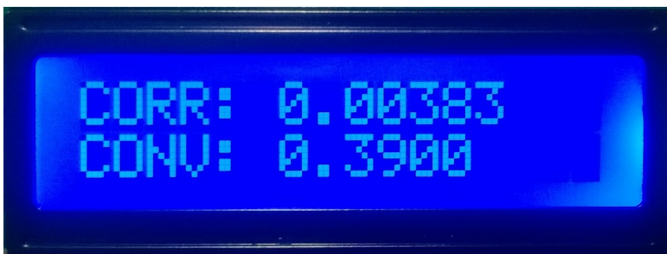
Obrázek 3.4: LCD displej – režim zobrazování konstant; nahoře (CORR) délka mrtvé doby trubice v sekundách; dole (CONV) přepočítání mezi reálnou hodnotou CPS (v této době je již započítána i mrtvá doba trubice) a \mu\text{Sv/h} .
