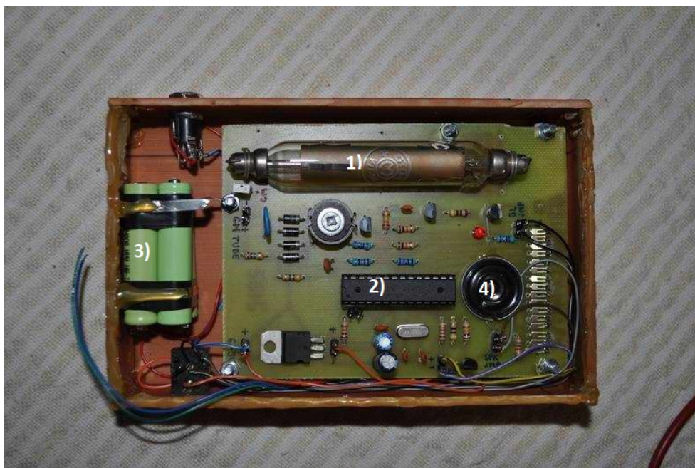
Obrázek 1.10: Domácí zařízení z baveno šasi. Na obrázku jsou vyznačeny důležité části: 1) Geiger-Müllerova trubice CTC-1 2) Mikrokontroler ATmega 8 3) 4 Ni-MH AAA baterie 4) Reproduktor. Upraveno z [27].
