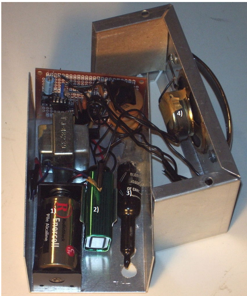
Obrázek 1.8: Domácí zařízení 1 rozebrané a s číselně vyznačenými důležitými částmi: 1) 1,5V Baterie 2) 9V Baterie 3) Geiger-Müllerova trubice 4) Reprodukční. Upraveno z [26].
