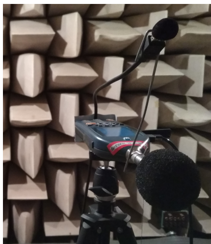
Obrázek 5.13: Umístění zvukoměru a mikrofonu při měření mikrofonních charakteristik
