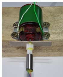
Obrázek 4.3: Použité zapojení pro měření konstanty motoru
