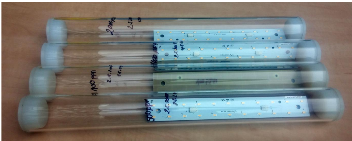
Obrázek 29. Utěsněné válce s oxidem siřičitým koncentrací 100 ppm, 500 ppm, 1000 ppm, 2000 ppm
