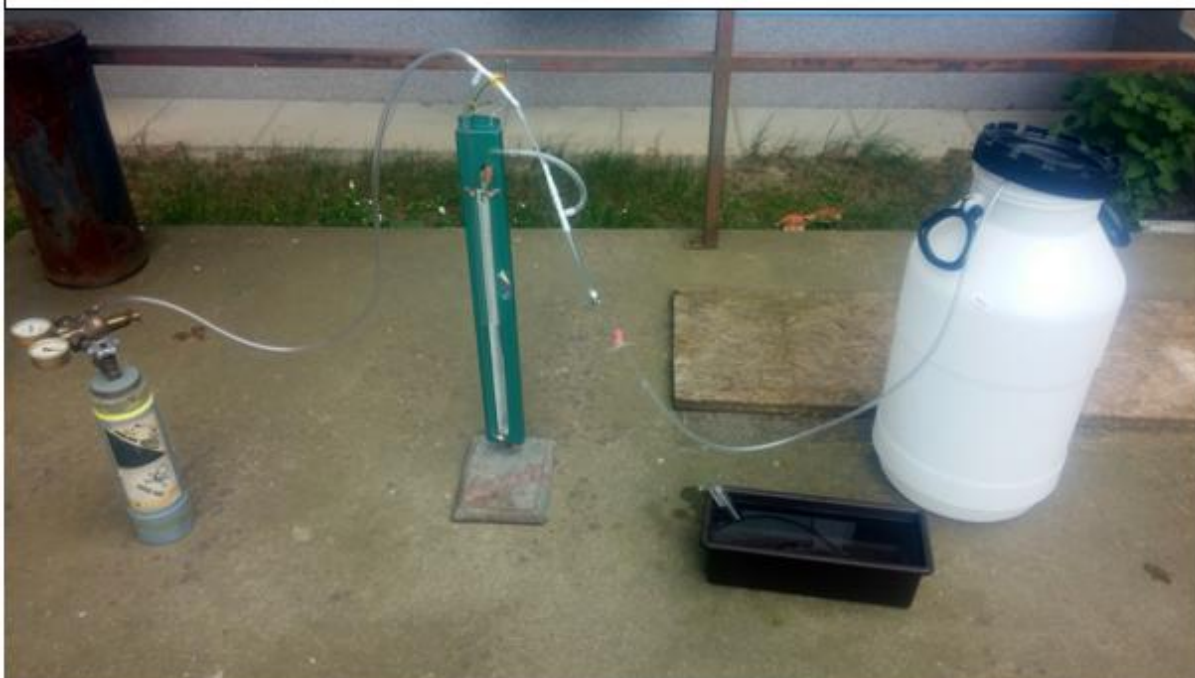
Obrázek 28. Sestavená aparatura sloužící k přesnějšímu dávkování oxidu siřičitého
