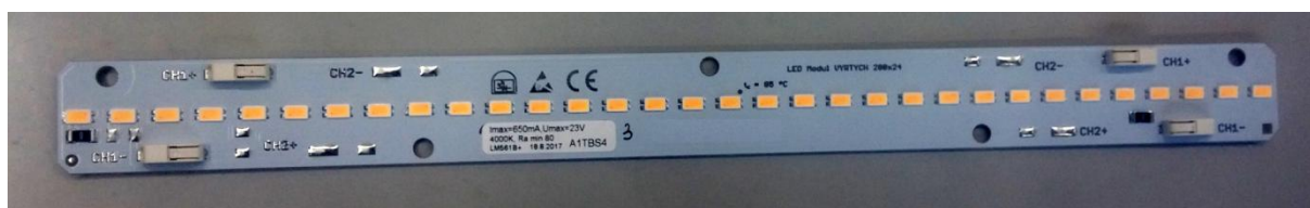
Obrázek 26. LED pásek, U_{max} 23 V, I_{max} 650 mA, t_{cmax} 85 °C pro použití do válců
