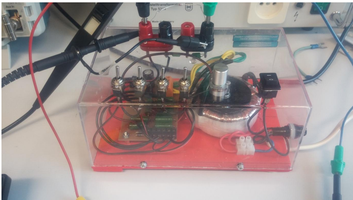
Obrázek 30. Přípravek sloužící k měření Voltampérových charakteristik
