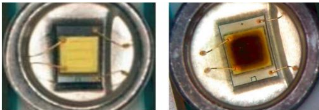
Obrázek 18. Vlevo je LED čip v normálním stavu, vpravo byl čip vystaven působení VOC při vysokém světelném výkonu při jmenovitých teplotách prostředí [26]
