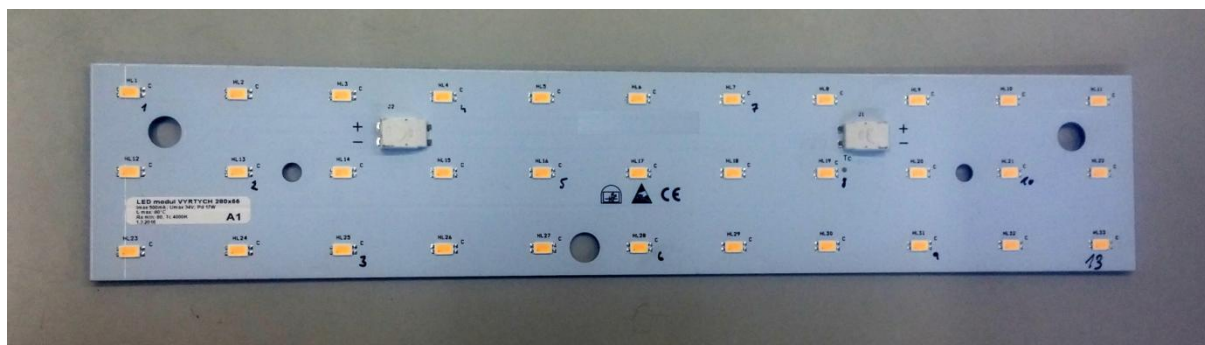
Obrázek 24. Používaný modul Vyrtých 280x66 mm, U_{max} 34 V, I_{max} 500 mA, t_{cmax} 80 °C
