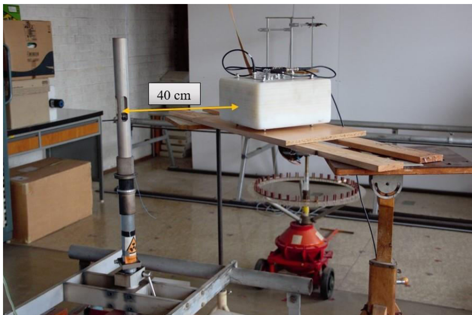
Obrázek 29. Umístění detektoru 40 cm horizontálně od držáku
