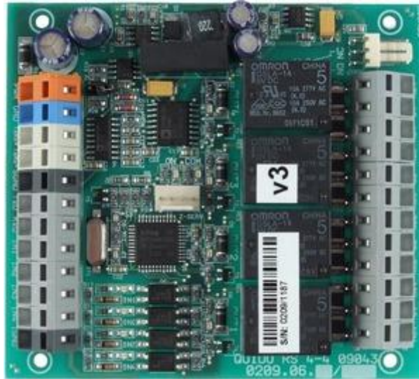
Obr. 6 - Quido se čtyřmi vstupy a čtyřmi výstupy s komunikací po RS485 [6]
