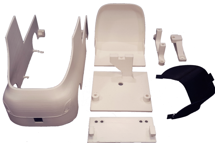
Obrázek 2.3: Navrhnuté díly vytištěné 3D tiskárnou
