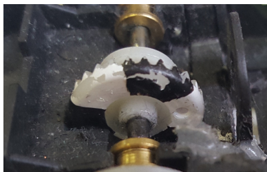
Obrázek 1.2: Degradace barvy starého ozubeného kola
