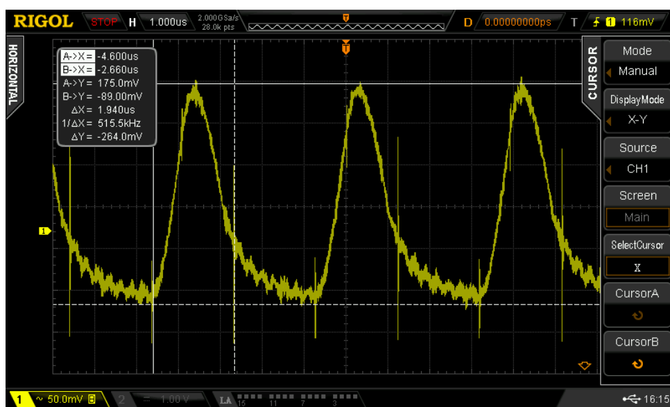
Obrázek 5.3: Měření Step-Down verze 1
