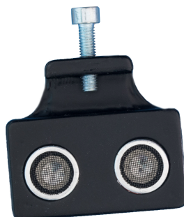
Obrázek 5.15: Realizace - ultrazvukový senzor
