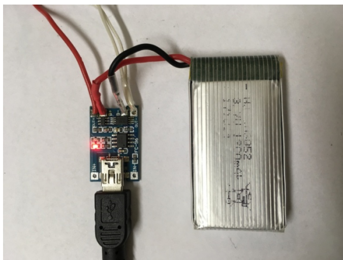
Obrázek 32: Ochranný modul pro nabíjení a vybíjení baterie společně s baterií v průběhu nabíjení
