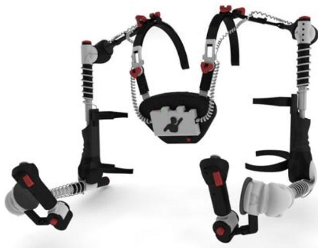
Obrázek 11: Obrázek typického exoskeletu torza snímající úhly v jeho kloubech, převzato z [7]
