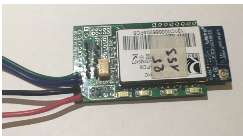
Obrázek 31: Wi-Fi modul WiFly RN131 s připájenými vodiči ke komunikaci s jednotkou SensorTile a k samotnému napájení modulu
