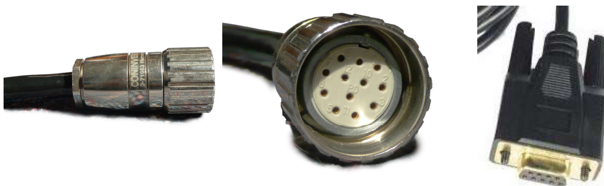
Obrázek 9: Konektory kabelu pro připojení inkrementálního čidla k Mainboard, vlevo a uprostřed konektor strany inkrementálního čidla, vpravo D-sub 9 zásuvka ze strany základní desky.
