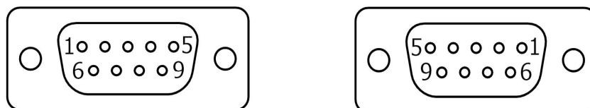
Obrázek 8: Číslování kontaktů konektoru D-sub 9 vlevo vidlice, vpravo zásuvky.
