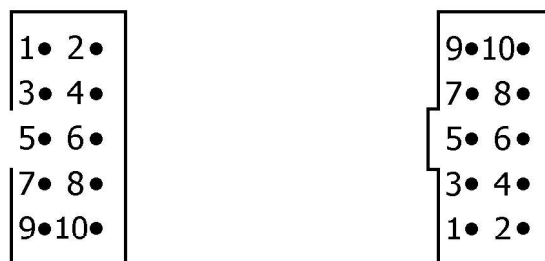
Obrázek 7: Číslování kontaktů konektoru PFL vlevo zásuvky na kabelu, vpravo vidlice na základní desce
