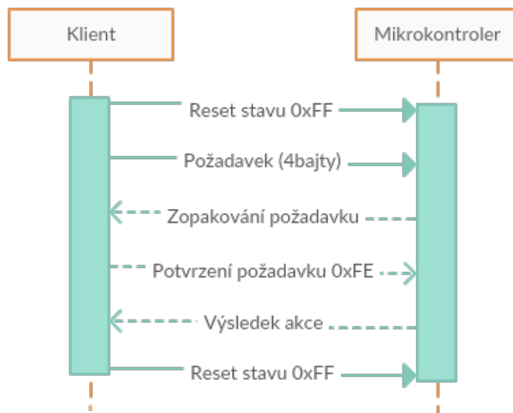
Obrázek 2.4. Sekvenční diagram požadavku na mikrokontroler
