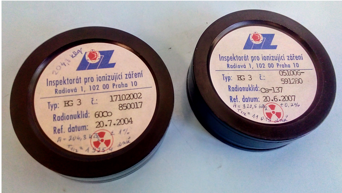
Obrázek 6.2. Kalibrační zdroje ionizujícího záření ^{60}\text{Co} a ^{137}\text{Cs}
