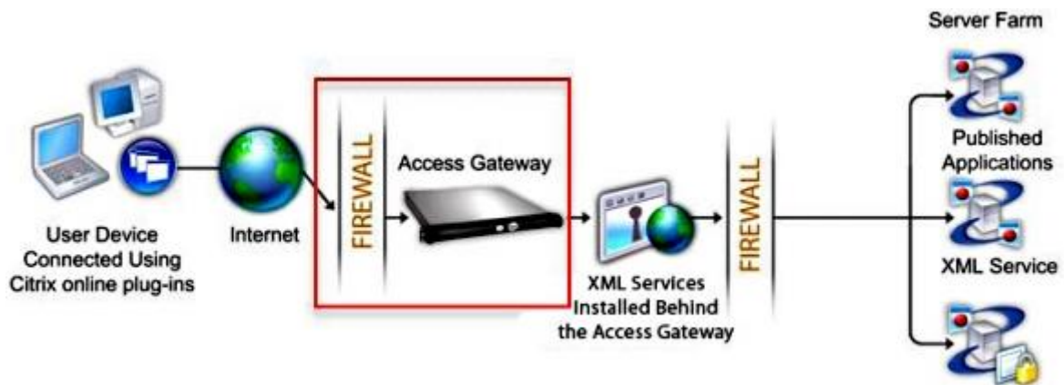
Obr. 4.7: Topologie připojení ke vzdálenému serveru přes aplikaci Citrix Reciever
