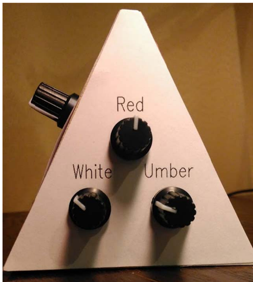
Obrázek 22 – Pravá boční část konzoly pro ovládání inteligentního svítidla (vlastní foto)
