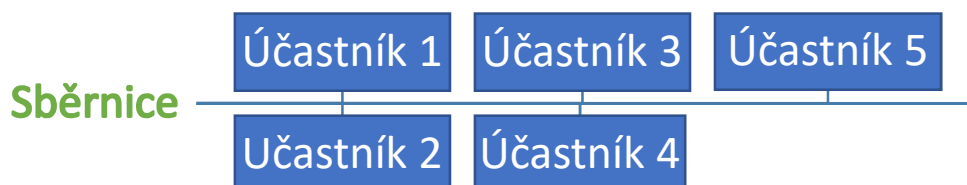
Obr. 5: Schéma liniové topologie [13]
