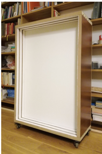
Obrázek 3.9: Hotová konstrukce testovacího vzorku s difuzorem z Corianu
