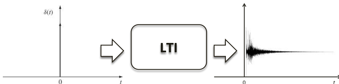
Obrázek 1: Princip impulsově odezvy LTI soustavy
