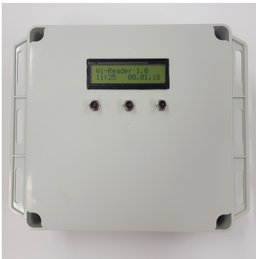
Obrázek E.3: Fotografie spodní strany čtečky s umístěnými prvky ovládání.
