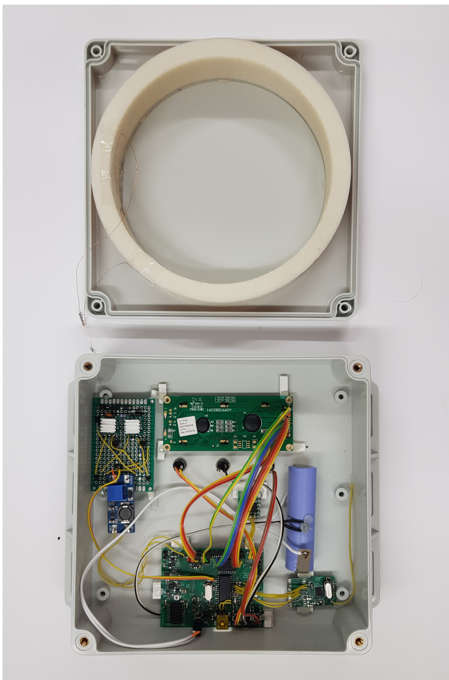
Obrázek E.4: Fotografie rozmístění elektroniky uvnitř čtečky.
