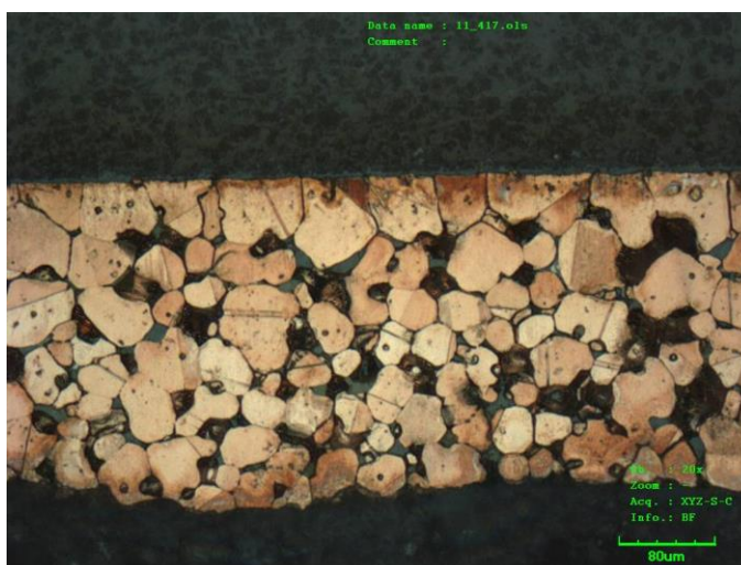
Obr. 13: Kontrolní výbrus nanesené měděné vrstvy na substrát [29]
