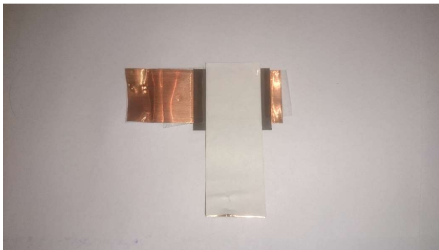
Obrázek 21: Senzor o velikosti snímací plochy 4\text{ cm}^2 vytvořený z měděných pásků a Velostatu
