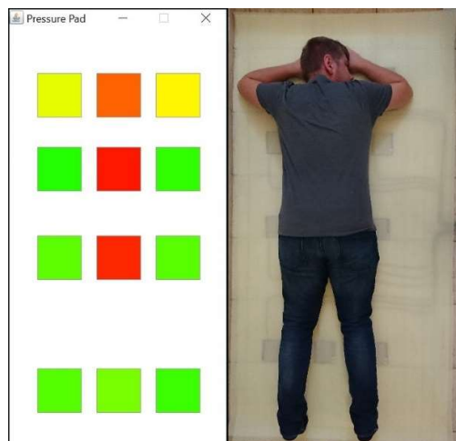
Obrázek 33: Testování senzoru při ležení na břiše
