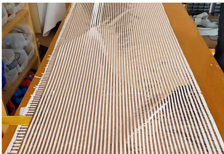
Obrázek 11: Vytvoření jedné vodivé vrstvy (řádků) [6]
