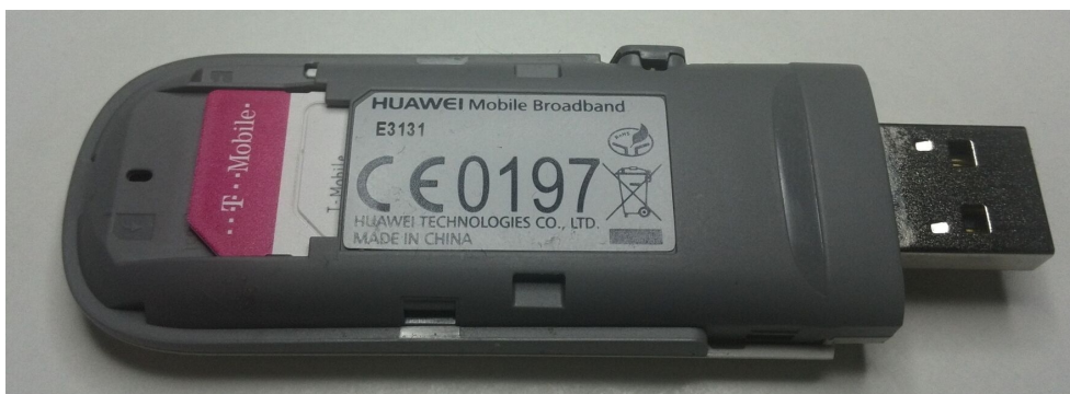
Obrázek 2.3: GSM modul Huawei E3131 s odkrytým slotem pro SIM kartu.
