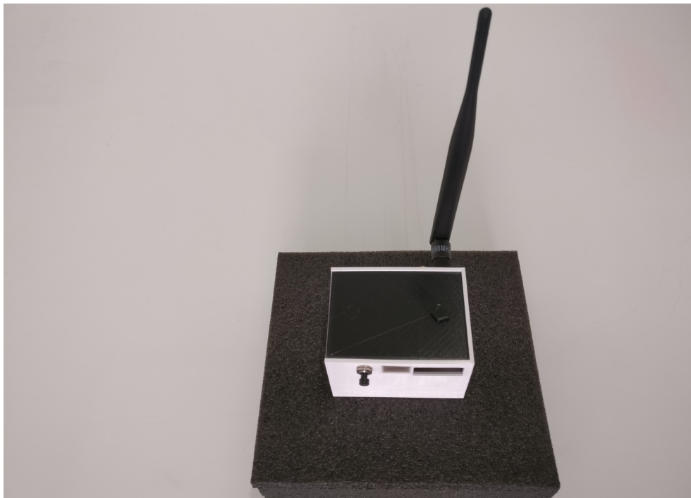
Obrázek 4.5: Sestavený testovací senzor v boxu z 3D tiskárny
