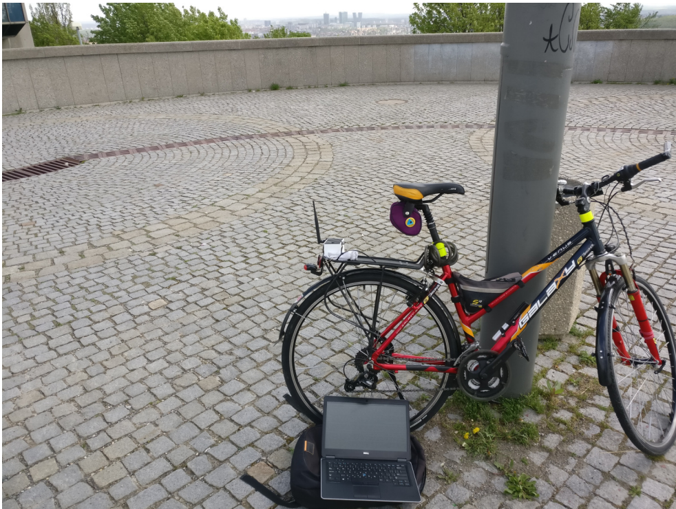
Obrázek B.4: Testovací kolo - mapování síly signálu
