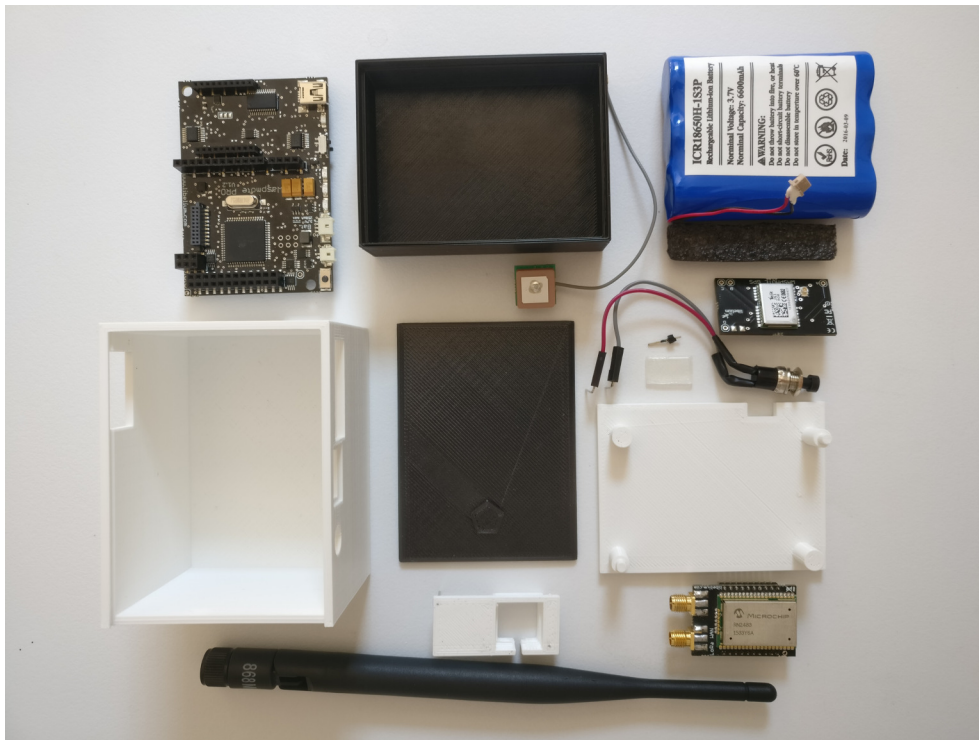
Obrázek C.1: Sestavení senzoru - přehled jednotlivých dílů
