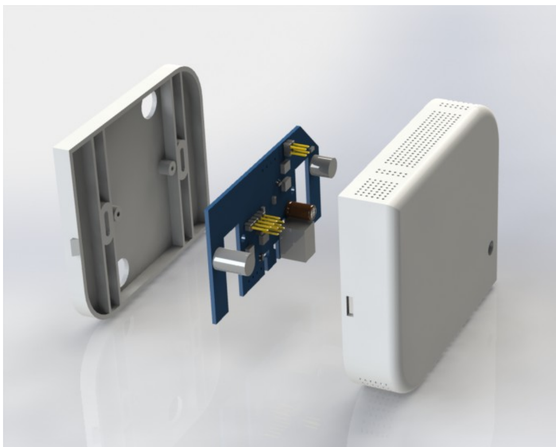
Obrázek 51 Návrh krabičky pro předělanou verzi Ing. Skřivánka
