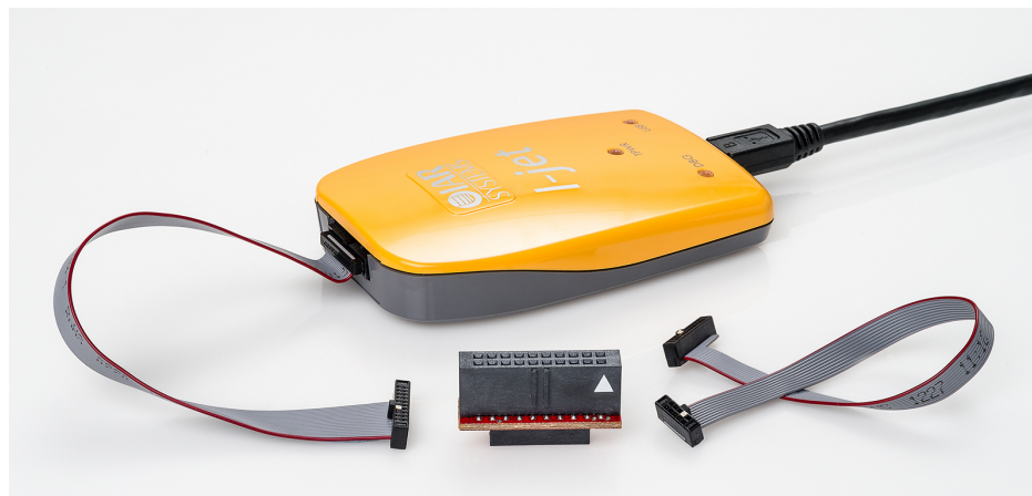
Obr. 14 Ladící nástroj I-Jet [11].
