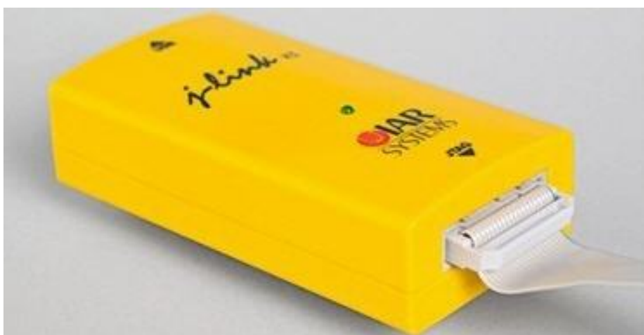
Obr. 13 Ladící nástroj J-Link [10].
