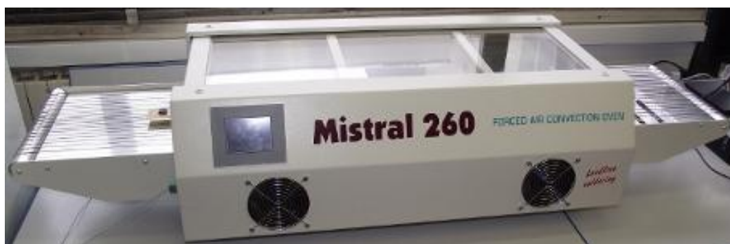
Obrázek 20 – Průběžná pec Mistral 260 [25].
