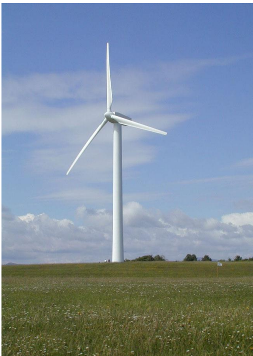
Obr. 7 Třílopatková vztlaková turbína
