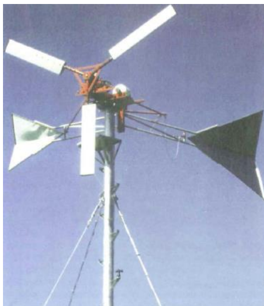
Obr. 17 – Regulace VtE malého výkonu pomocí regulačních kormidel
