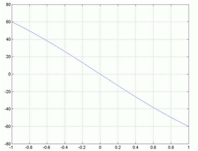
Obr. 30 – Graf závislosti relativní pozice odbočky (k) a fázového posunu ( \psi )
