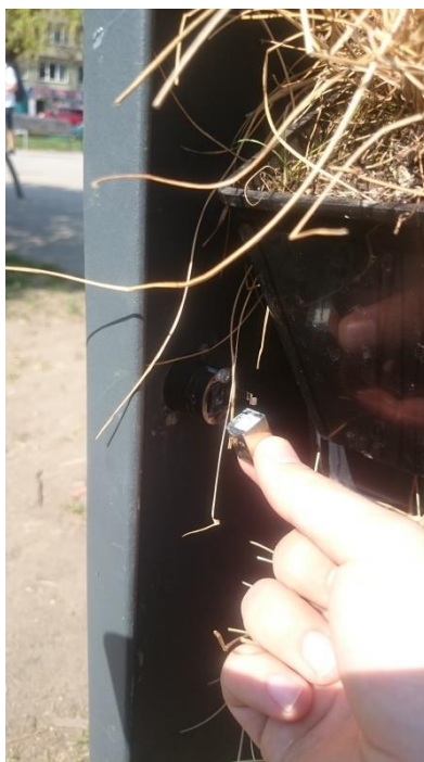
Obrázek 5.1 Rozbitý konektor zásuvky chytré lavičky na Puškinové náměstí
