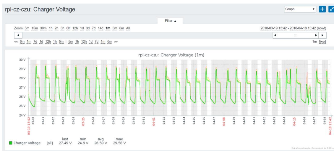
Obrázek 6.1 Graf napětí na výstupu regulátoru chytré lavičky ČZU v intervalu 1 měsíce
