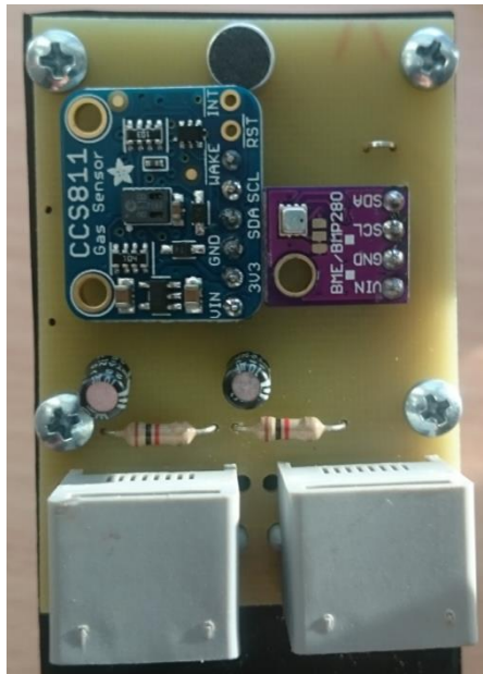
Obrázek 3.9 DPS se senzorem BME 280, CCS811 a mikrofonem
