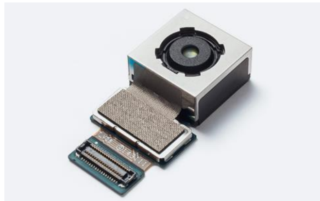
Obrázek 7.1 - Modul fotoaparátu se senzorem společnosti Samsung pro mobilní telefon [28]
