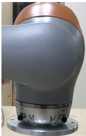
Obrázek 2.6: Rozšířená příruba pro uchycení chapadla, nástroje a nebo snímače.
