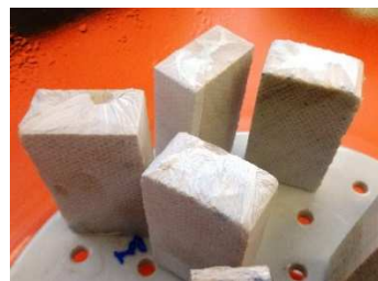
Obr. 20 Obalování infikovaných dřevěných vzorků do nanovláknité textilií s různými biocidními příměsi
