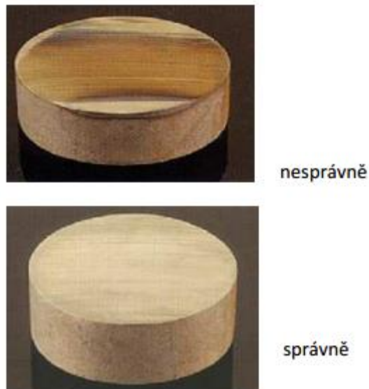
Obr. 5.7 Porovnání správně a nesprávně chlazeného řezu [7]
