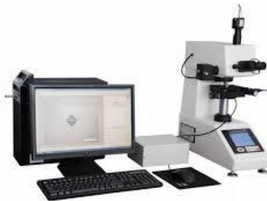
Obr. 5.4 Mikrotvrdoměr s podporou PC [9]
