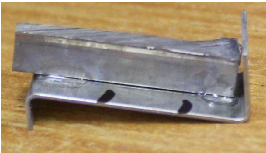
Obr. 6.6 Úhlový přípravek s preparovaným vzorkem
