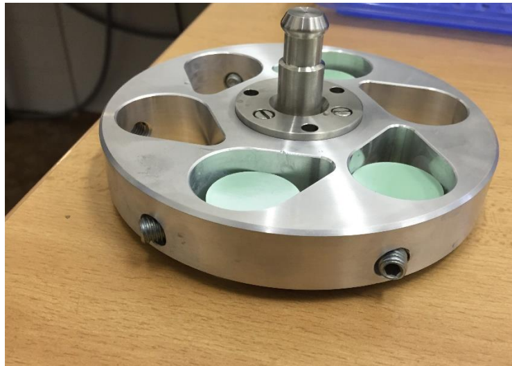
Obr. 6.9 Přípravek se vzorky
