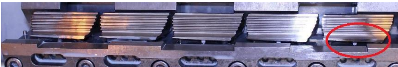
Obr. 6.1 Přípravek s upnutými lopatkami. Pátá lopatka s označením popalu
