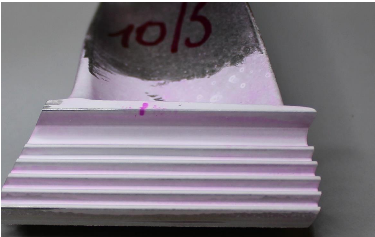
Obr. 6.18 Detail lopaty 10/5 při vyhodnocování zkoušky
