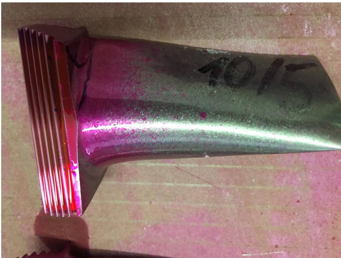
Obr. 6.16. Lopatka 15/5 po nanesení detekční tekutiny
