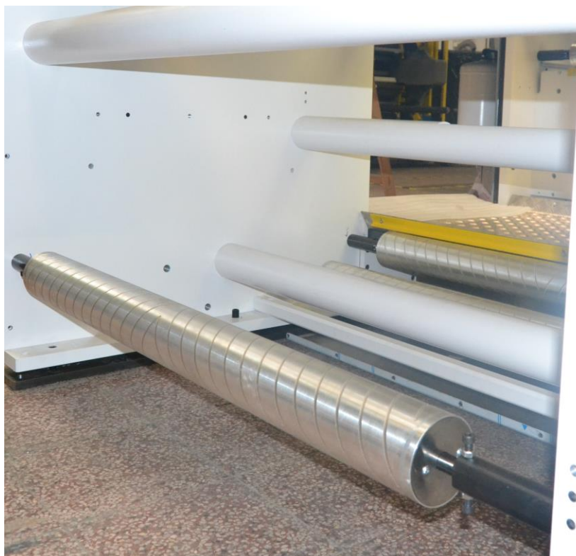
Obr. 2-2 Vodící válec s příčnickou (natřené bílou barvou) [autor]
