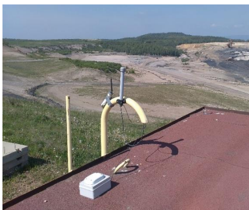
Obrázek 20 - Rozmístění antén GNSS přijímače a X-Bee na pozorovací stanici Citron
