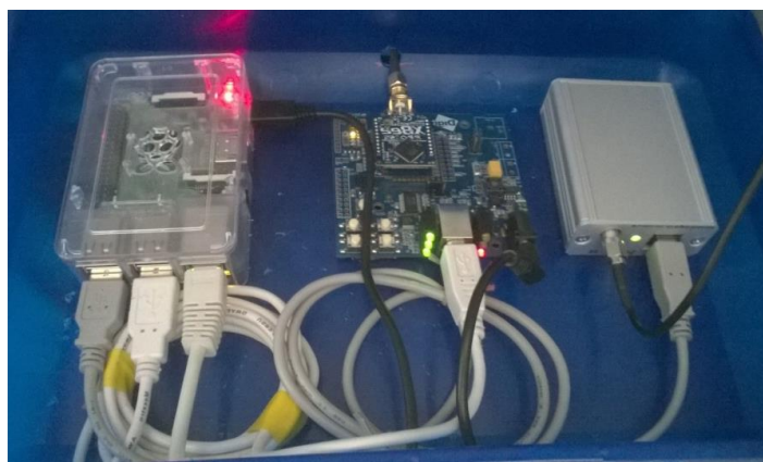
Obrázek 19 - Zařízení na pozorovací stanici Citron (zleva: Raspberry Pi, X-Bee, U-blox)
