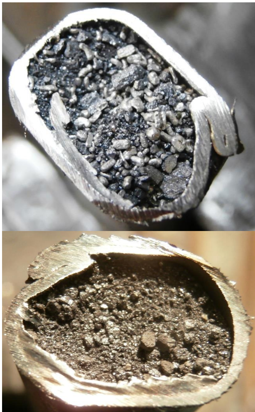
obr. 7 - řez plněným profilem ( nahoře modifikátor, dole očkovadlo ), jiný odstín snímku očkovadla je způsoben použitím jiného nasvícení než při fotografování modifikátoru, snímky byly pořízeny v METALURGII Rumburk s.r.o
