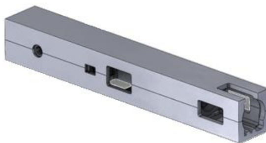
obr. 13 - 3D model smykadla ze stroje WHR 13 (Q)
