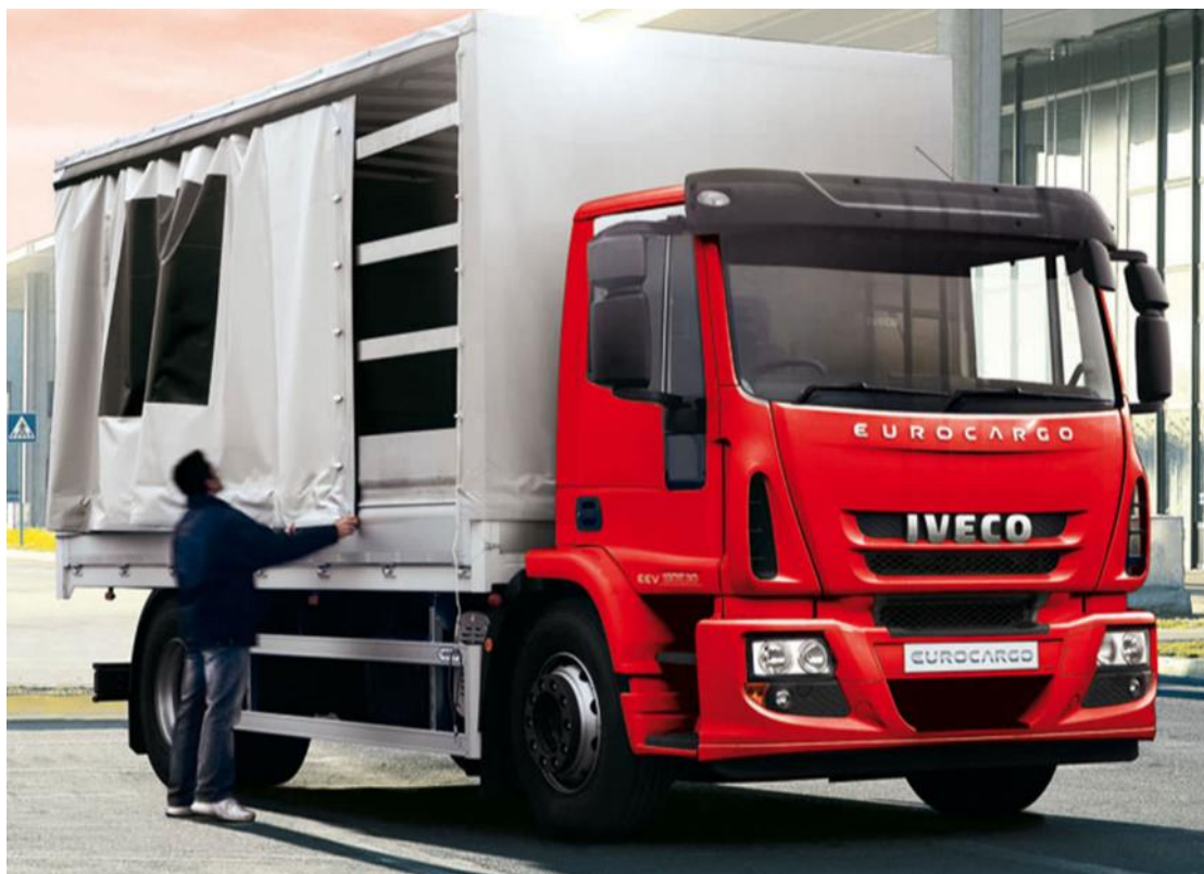
Obr. 2: Valníkový nákladní automobil s bočnicemi a stahovací plachtou
