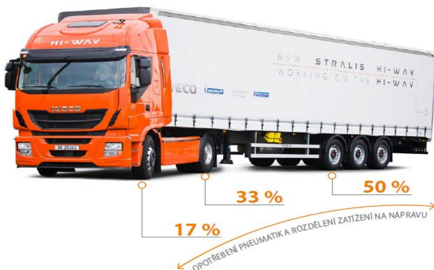
Obr. 14: Opotřebení pneumatik a rozdělení zatížení na nápravu
