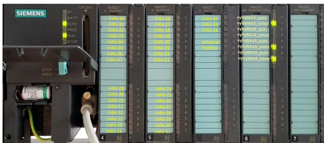
Obrázek 7: Popis konkrétního adresování vstupů / výstupů v laboratoři
