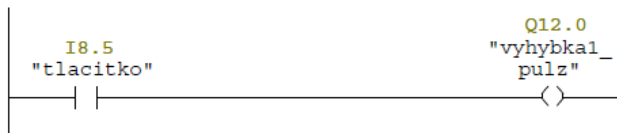
Obrázek 22: Ovládání výhybky V1
