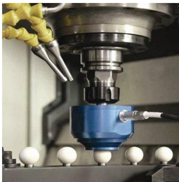
Obr.8. Samocentrovatelná hlava v kombinaci s měřícím artefaktem [7]
