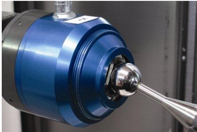
Obr. 5. Samocentrovatelná hlava v kontaktu s měřící koulí [7]
