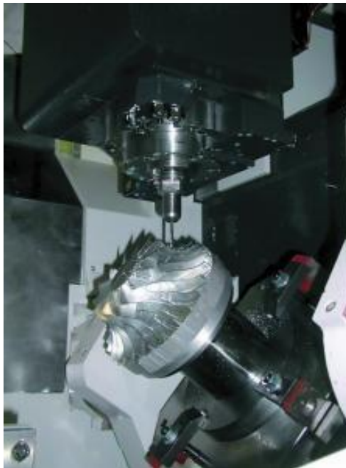
Obr. 12. Výroba lopatkového kola kompresoru [3]
