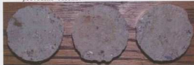
Obr.C99-112 Zkušební terče číslo 67, 68, 69 (zkušební místo 3) po provedení odtrhu.
