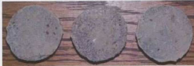
Obr.C99-110 Zkušební terče číslo 58, 59, 60 (zkušební místo 1) po provedení odtrhu.
