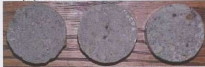
Obr.C99-111 Zkušební terče číslo 61, 62, 63 (zkušební místo 2) po provedení odtrhu.
