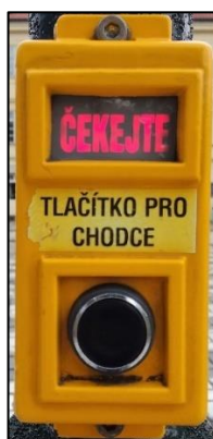
Obrázek 12 Tlačítko pro chodce umístěné na sloupu veřejného osvětlení
