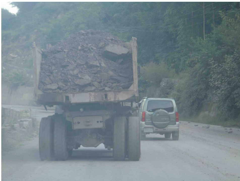
Obr. 7.12 Množství rubaniny na nákladním vozidle přesahující rozumnou míru; navíc chybí zadní sajtna.
