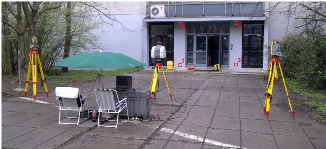
Obr. 5.17: Pohled na měření pilíře s vyznačením kontrolních bodů.
