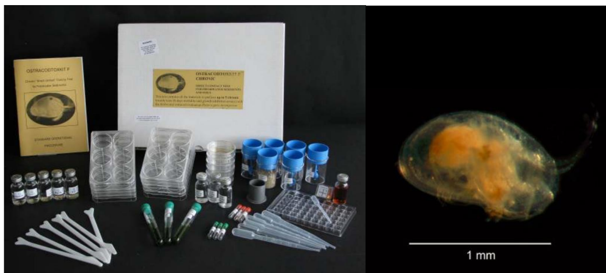
Obrázek 5: Vyobrazení sady pro kontaktní 6-ti denní test a testovaný organismus Heterocypris Incongruens
